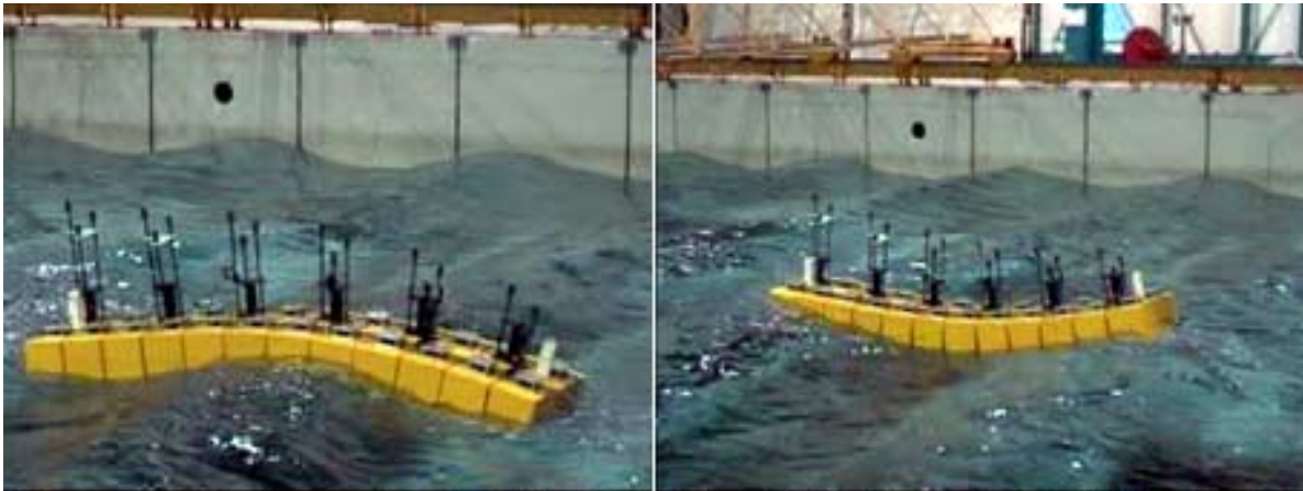
Figure 3: Comportement de la barge lors des essais (Configuration 1).
