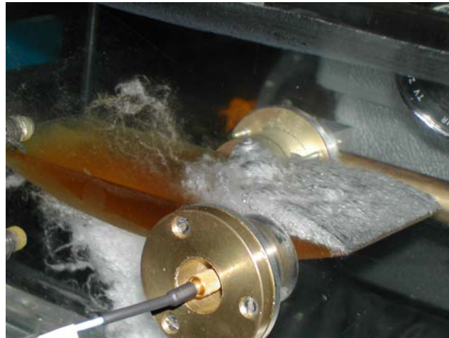
Figure 1. Poche de cavitation sur la face en dépression du foil
