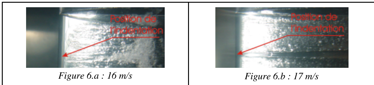
Figure 6 : Visualisation de cavitation attachée pour deux vitesses de l'écoulement ( \alpha = 4^\circ , \sigma = 1 ).
