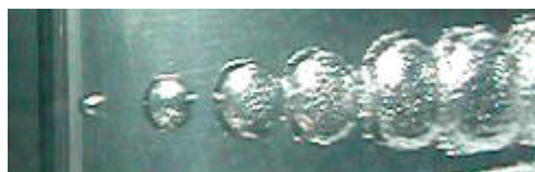
Figure 3 : Visualisations de cavitation par bulle sur un profil NACA 65012.
