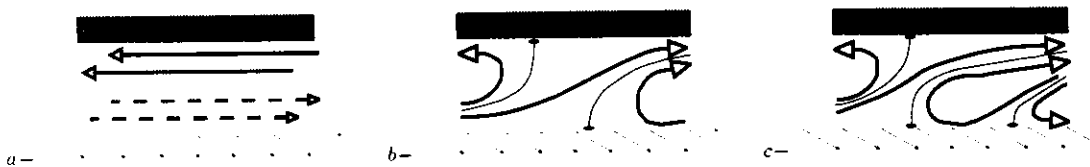
FIG. 7 - Schéma de la circulation moyenne sous une plaque au milieu d'un ensemble de 5 plaques pour les clapots 1 (—) et 2 (- -) - fortes cambrures et faibles amplitudes (a); pour le clapot 3 (b); et 4 (c) - faibles cambrures et fortes amplitudes (sont indiqués les lignes de courant séparatrices ainsi que les points d'arrêt).
