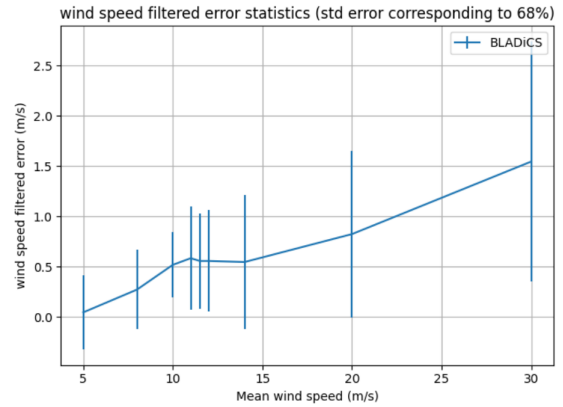
(b) Erreur d'estimation de l'estimateur de vent de BLADiCS \hat{ws}(t) - ws(t)
