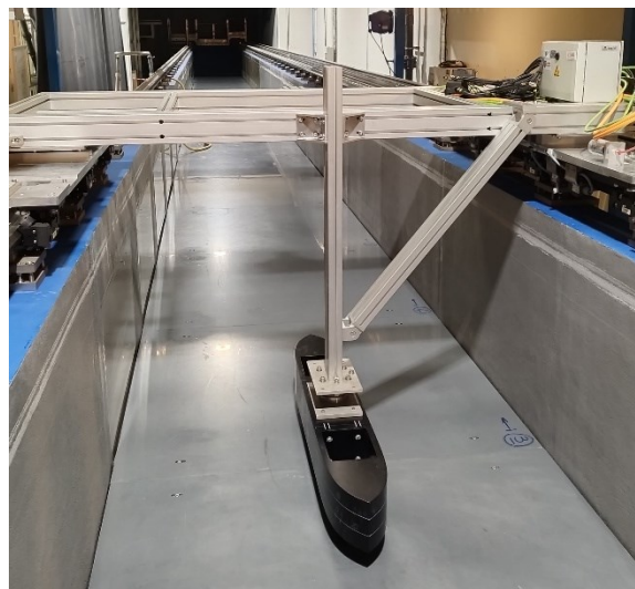
Figure 2 : chariot de traction et maquette utilisée
