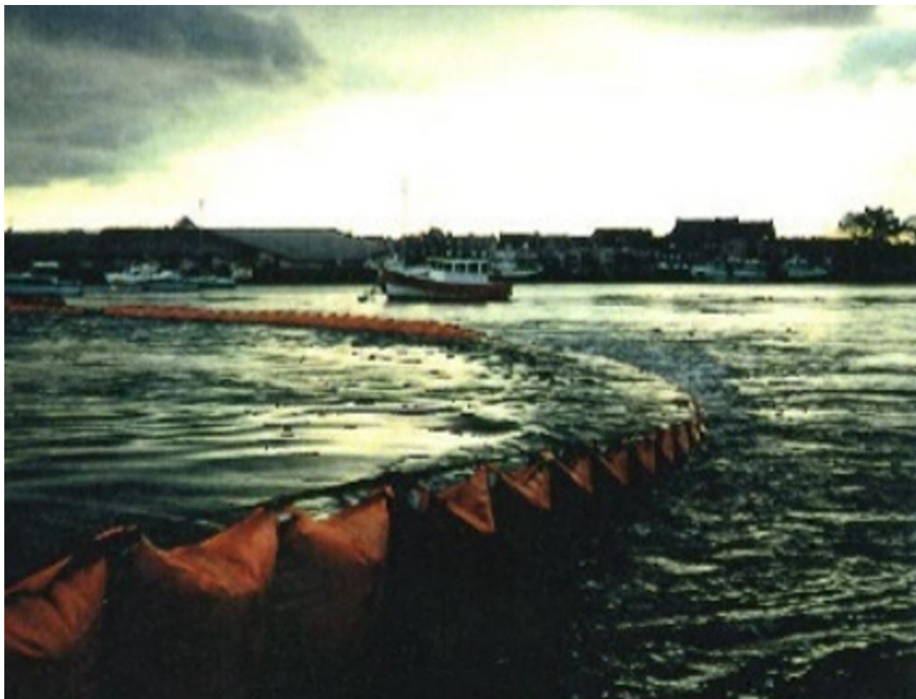
Figure 1. Barrage anti-pollution BALEAR 335 retenant une masse d'eau importante à marée basse, CEDRE 1994
