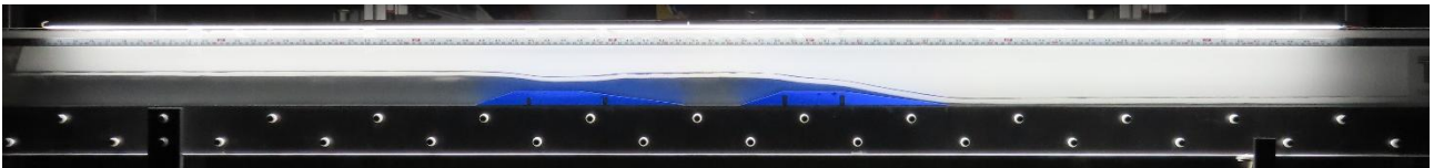
Figure 1. Montage expérimental avec deux obstacles obtenus par impression 3D en ABS bleu. Un fond blanc et un rail de LED permettent d'observer le ménisque en noir entre deux bandes blanches.
