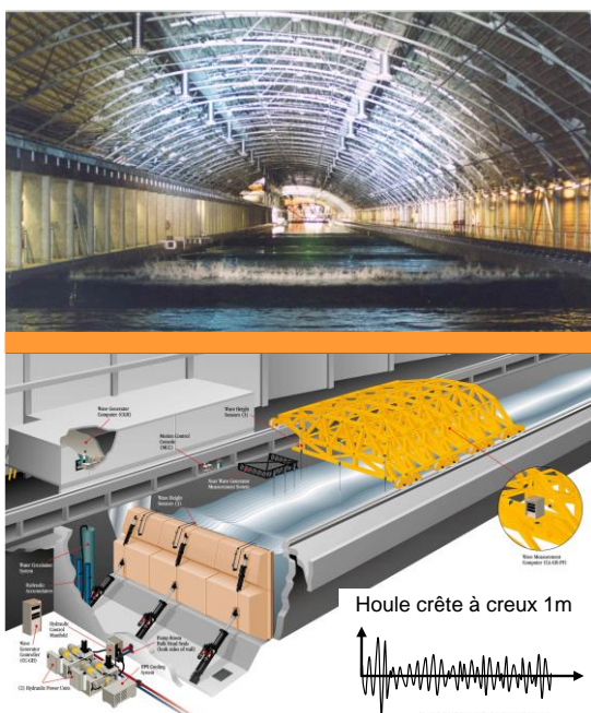
Figure 1 : Bassin de traction avec générateur de houle (état de mer 8-9 à l'échelle 1/20 – 1/30)
