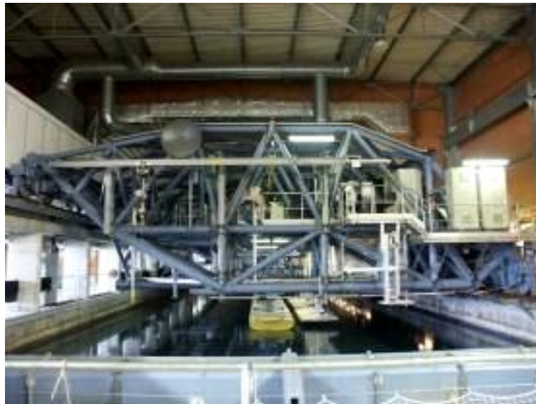
Figure 3 : Plate-forme du Bassin de traction B600
