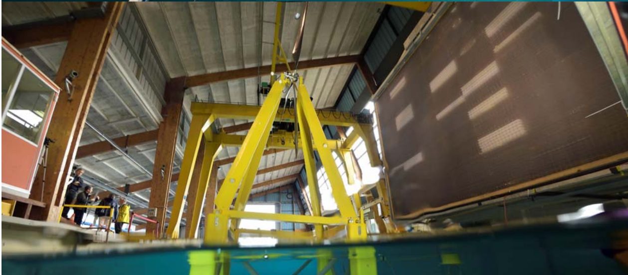
Figures 1a et 1b : éolienne flottante ROTOR et éolienne flottante EOLINK. Tests au bassin de l'Ifremer Centre de Bretagne en présence de houle et de vent.
