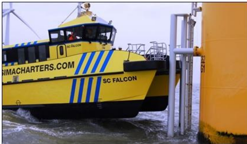
Fig. 2 - Accostage en mer d'un CTV avec une défense « high friction » à un embarcadère [2]
