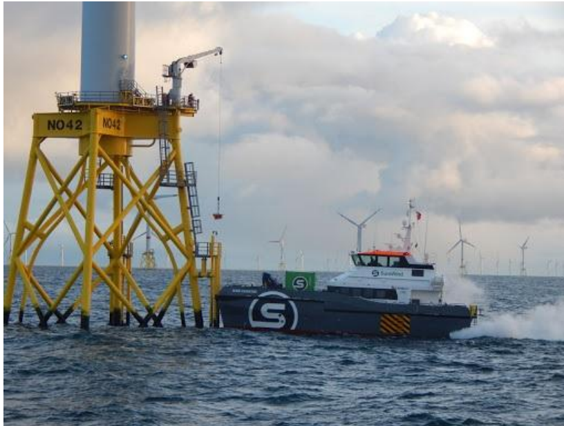
Fig. 1 - Accostage en mer d'un CTV avec une défense « low friction » à un embarcadère [1]
