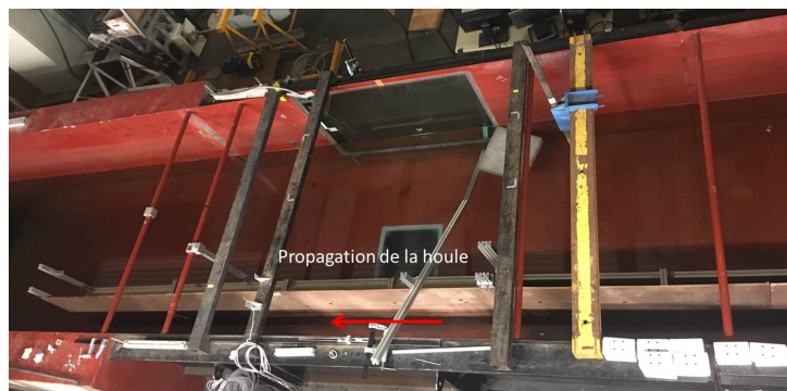
FIGURE 4 – Vue de dessus du canal mis en place.
