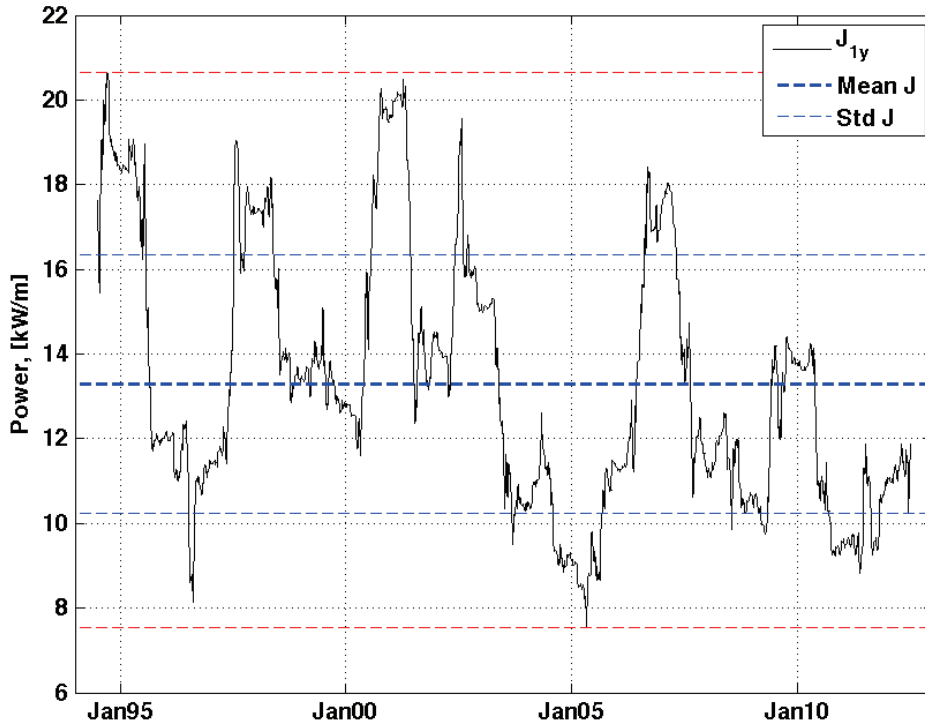
Fig. 3 – Moyenne annuelle de puissance linéique estimée sur SEMREV à partir des 19 ans de rejeu HOMERE.
