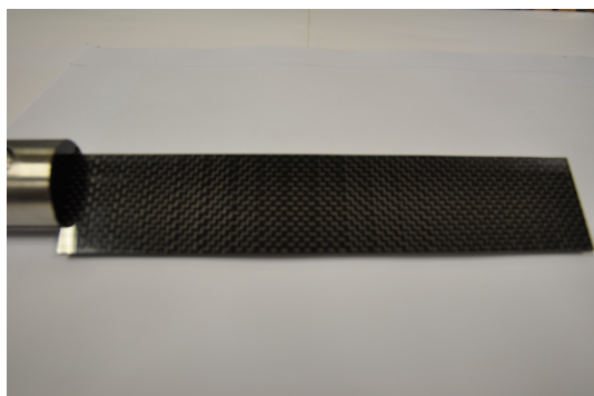
Figure 2: Gauche) Plaque plane rigide en carbone de 3 mm d'épaisseur, 191 mm d'envergure et 40 mm de longueur. Droite) Vue du plan laser PIV à mi-envergure de la plaque oscillante au sein du tunnel hydrodynamique.
