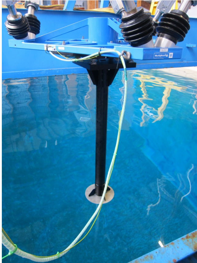
Figure 3 : De haut en bas : hexapode, balance, mât, goussets, plaque
