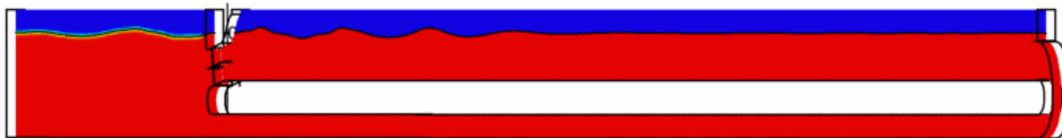
Figure 5: Exemple de génération de houle. La période est 2 secondes. A droite du dispositif, dans le bassin, on peut voir la houle se propager. On constate l'existence d'harmoniques d'ordre élevé alors que le forçage est monochromatique.
