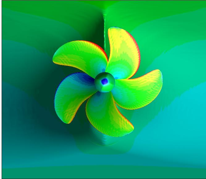
Figure 7 – Vue de l’arrière de la pression instantanée (moins la pression hydrostatique) sur la carène et l’hélice.
