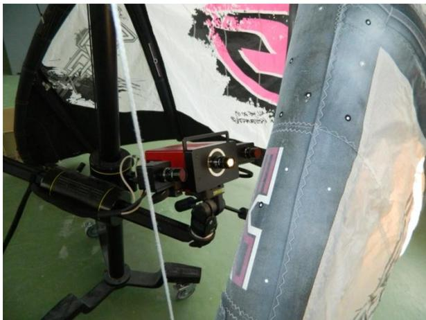
**Figure 6: Système de scan 3D Gom en phase d'acquisition de la géométrie tridimensionnelle du kite F-one Revolt**
