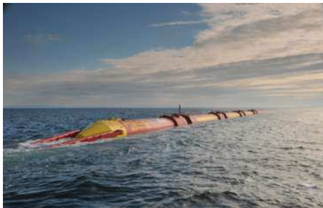
Figure 1 : Le système houlomoteur Pelamis PII en mer
