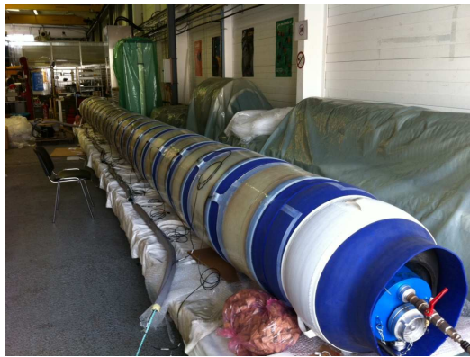
Figure 4. Maquette pendant son assemblage – Test de gonflage.
