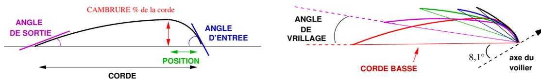
TAB. 1 – Caractéristiques du profil de la voile -  $AW S = 11,5 \text{ m.s}^{-1}$ ,  $AW A = 25^\circ$ .
