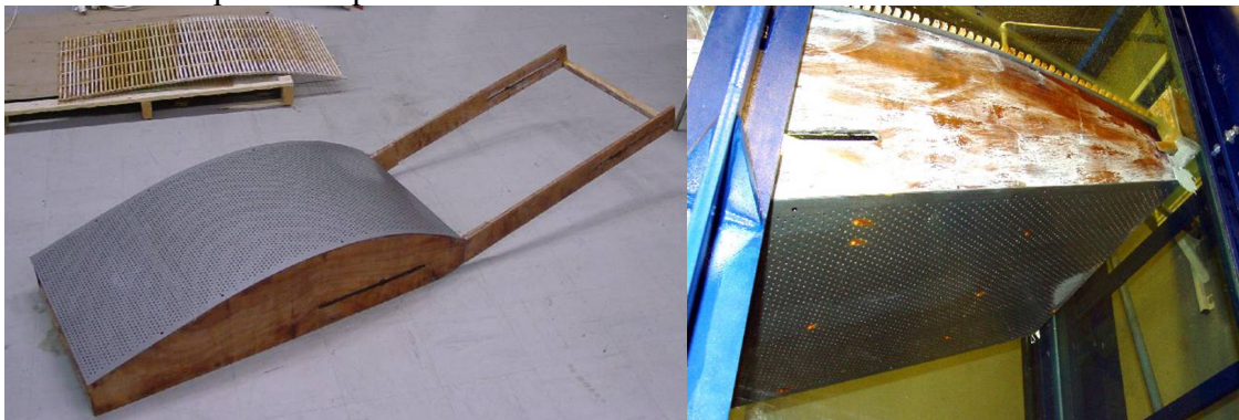
Figure 6 : Introduction d'une porosité de surface. Sur le dessus (gauche). Sous le dessous (droite)
