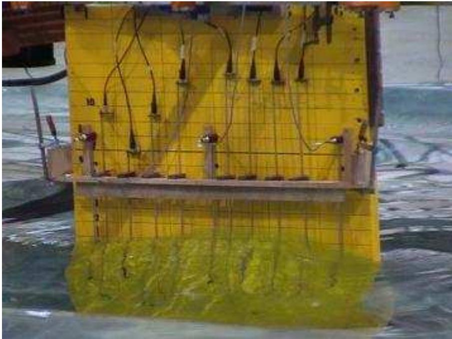
FIG. 3 – *Modèle expérimental avec ses sondes à houle.*
