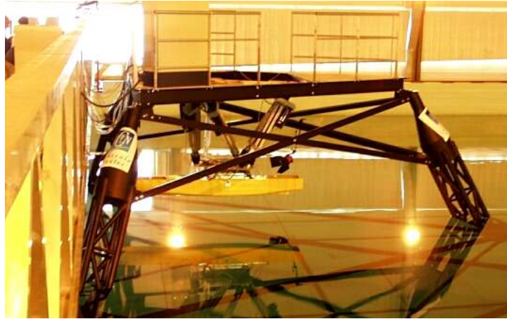
Figure 2: Le montage expérimental comprenant le tripode, l'hexapode, la balance et la maquette
