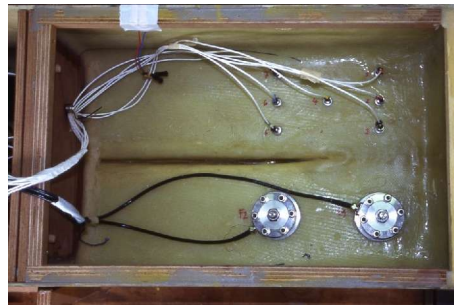
Figure 3: Capteurs de forces (bâbord) et de pression (tribord) implantés dans la carène pour la proue et la poupe.
