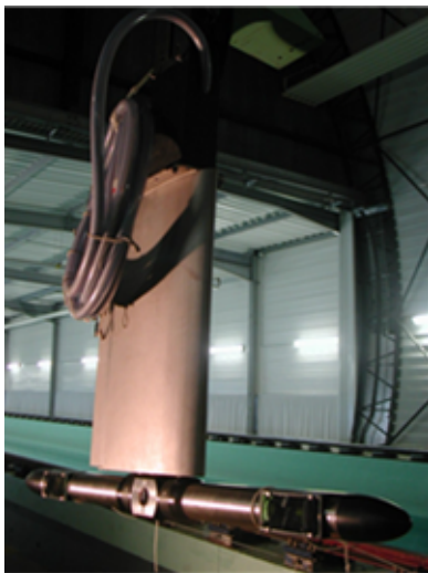
Figure 2 – Vue de la sonde caméra sur son support caréné
