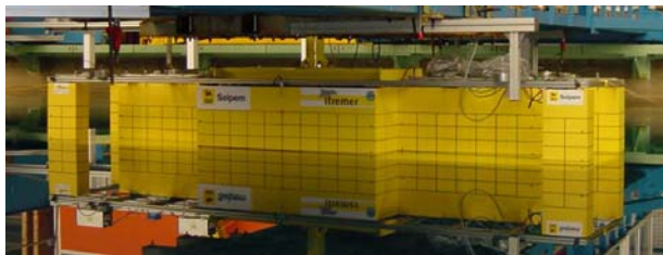
Fig. 3 : Maquette encadrée lors de l'étalonnage des sondes embarquées
